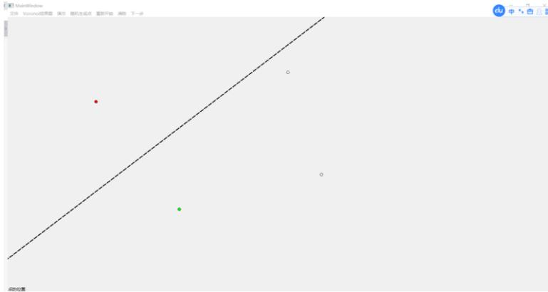
可以看到主界面第一步的结果，其中，红点表示分治算法中当前合并的左边 Voronoi 图涉及的点集，绿点表示分治算法中当前合并的右边 Voronoi 图涉及的点集，虚线表示二者的分割线。
