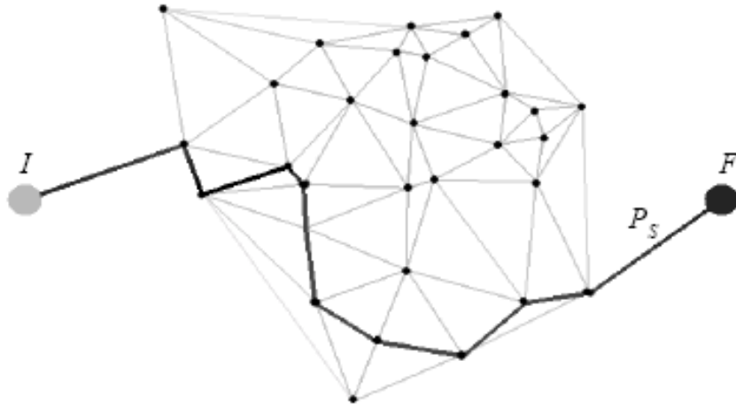
图 2 最优覆盖问题的 Delaunay Triangulation 解决方法(左边为进入点, 右边为飞出点)
