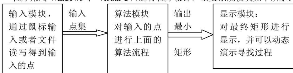
系统主要由以上三部分组成，采用 Windows SDK 写成。各个模块的作用由上面所示。支持文件读写操作，便于测试和理解算法流程。
